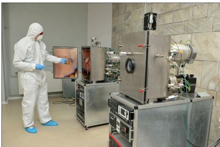
Виробництво епітаксійних плівок НВП "Електрон-Карат"
