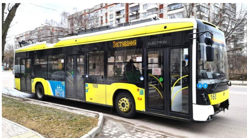
Тролейбус з автономним ходом на тестуванні в місті
